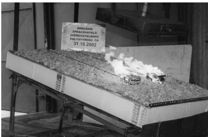
Zkouška s ochrannou vrstvou kačírku tl. 40 mm.
