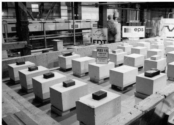
Úspěšná zkouška lehké ploché střechy s EPS na TR 150/280 (klasifikace REI 15 na rozpon 6 000 mm.)
