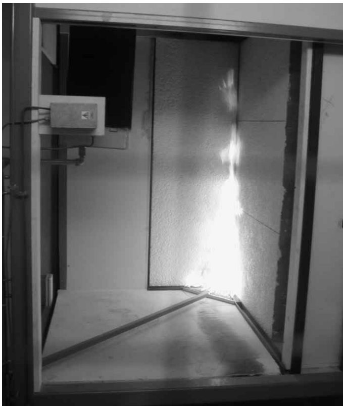
OBR. 5 Zkouška ETICS podle ČSN EN 13823
