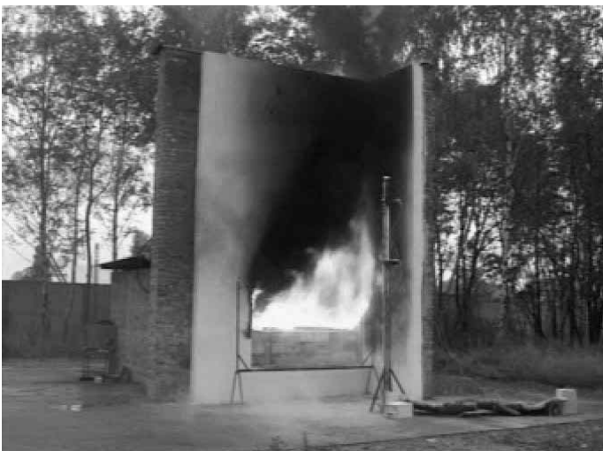
Obr.12 Zkouška zateplovacího systému ETICS s EPS podle ISO 13 785-2
