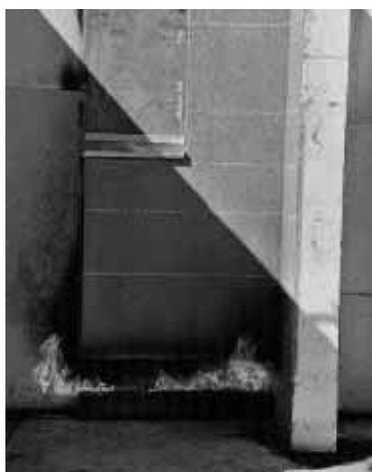
Obr. 11 Zkouška systému ETICS (oblast okenního nadpraží) v průběhu a po skončení zkoušky
