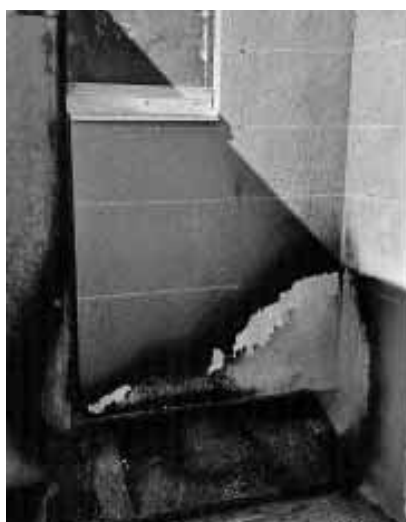
Obr. 11 Zkouška systému ETICS (oblast okenního nadpraží) v průběhu a po skončení zkoušky
