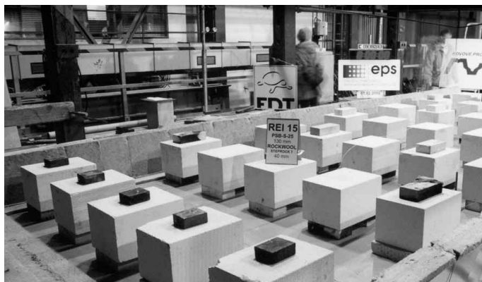
Obr. 2 Úspěšná zkouška lehké ploché střechy s EPS na TR 150/280 (klasifikace REI 15 na rozpon 6 000 mm.)
