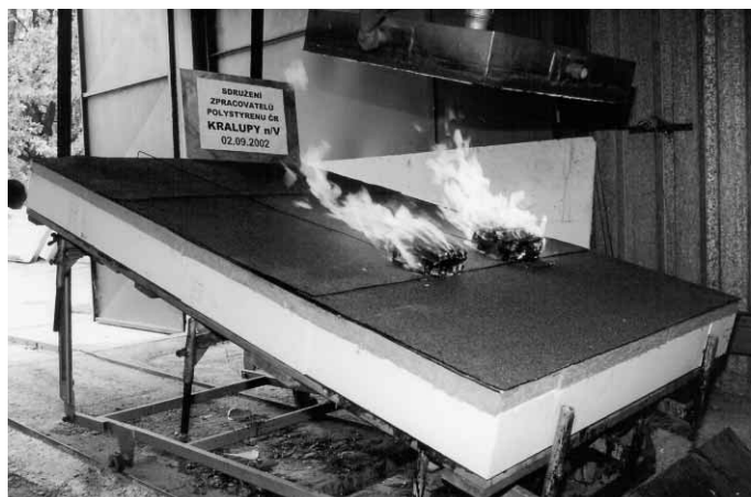
Obr. 4 Plochá střecha s EPS vhodná do požárně nebezpečného prostoru s ochrannou vrstvou minerální vlny tloušťky 40 mm.
